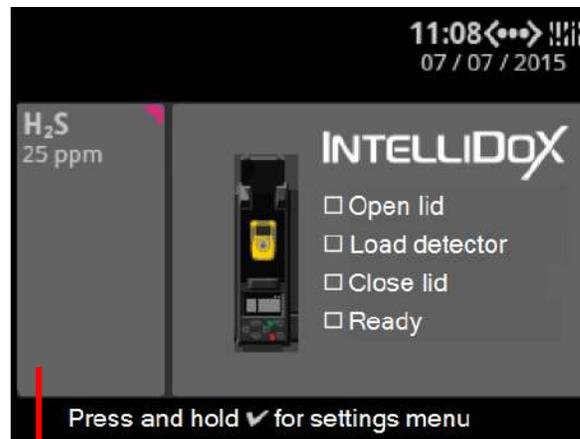
Переключатель одного входа: IntelliDoX включает вход газа 1 и отображает один подключенный цилиндр с газом.
