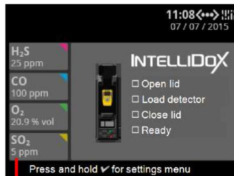
Переключатель нескольких входов: IntelliDoX включает входы газа 1, 2, 3 и 4 и отображает до четырех подключенных цилиндров с газом.
