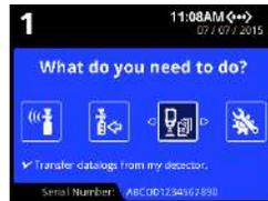
1. Установите совместимый детектор в модуль. **На ЖК-дисплее отображается Detector identification** (Идентификация детектора). После распознавания детектора выполняются процедуры, которые должны выполняться автоматически после установки детектора.
