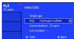
1. Для того чтобы настроить тип газа в многокомпонентной газовой смеси, выберите **Gas blend** (Газовая смесь) из меню **Inlet edit** (Редактировать вход), а затем нажмите **◀** или **▶**, чтобы выбрать один из газов, имеющихся в смеси.
