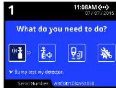
Проверка работоспособности — это процедура, которая подтверждает способность детектора реагировать на целевые газы путем воздействия газа с известной концентрацией на детектор. Данный модуль поддерживает два типа проверки работоспособности:
