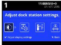
2. Нажмите **◀** или **▶** на клавиатуре, чтобы выбрать **Adjust display settings** (Изменить настройки дисплея), а затем нажмите, **✓** чтобы отобразить меню **Adjust display settings** (Изменить настройки дисплея).
