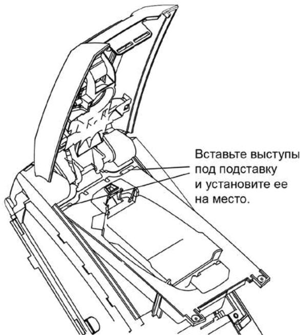
8. С помощью отвертки затяните два винта на заменяющей подставке для подзарядки.
