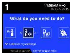
Калибровка — это двухэтапная процедура, которая определяет шкалу измерений для реагирования детектора на газ. На первом этапе определяют фоновые показания в чистых, незагрязненных окружающих условиях. На втором этапе датчики подвергают воздействию газа известной концентрации. Для определения шкалы измерений в детекторе используются фоновые показания и известные концентрации газа.
