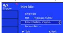
1. Убедитесь в том, что отображающаяся концентрация газа соответствует концентрации газа, который содержится в баллоне с калибровочным газом. Если концентрация не соответствует, выберите **Concentration:** (Концентрация:) из меню **Inlet edit** (Редактировать вход), а затем нажмите, **✓** чтобы отредактировать значение.
