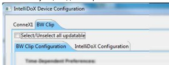
5. Выберите вкладку **IntelliDoX Configuration** (Конфигурация IntelliDoX). В случае необходимости измените доступные функции, опции и настройки. За дополнительной информацией обратитесь к руководству оператора ПО Fleet Manager II и руководству по эксплуатации соответствующего детектора.
